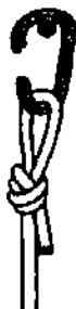
Рис. 31. Узел неустойчивый к переменным нагрузкам можно сравнить с карабином, у которого отсутствует замок.
