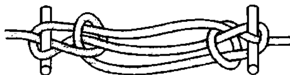
Рис. 132. Повышение безопасности колышки с помощью клевантов.
