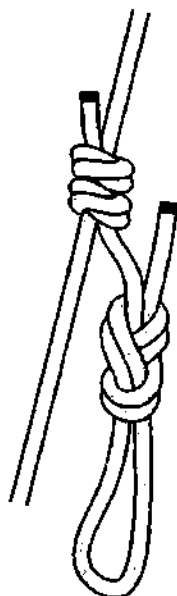
Рис. 788. Дополнительная петля для самостраховки при связывании двух веревок двойным рыбацким узлом у альпинистов.
