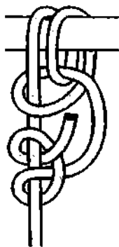
Рис. 541. Рыбацкий штык с обратным расположением полуштыков.
