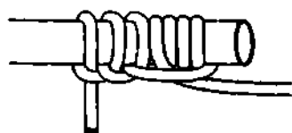
Рис. 605. Верблюжий узел с полуштыком и шлагом отлично подходит для привязывания темляка к концу древка.
