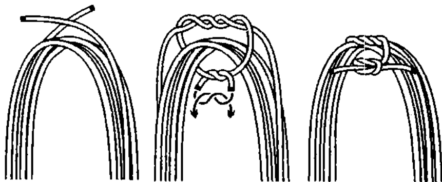
Рис. 1008. Скрепление бухты перевязочным узлом .
