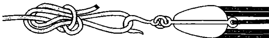
Рис. 484. Щучий узел с одной рабочей петлёй. Вторая петля затянута.
