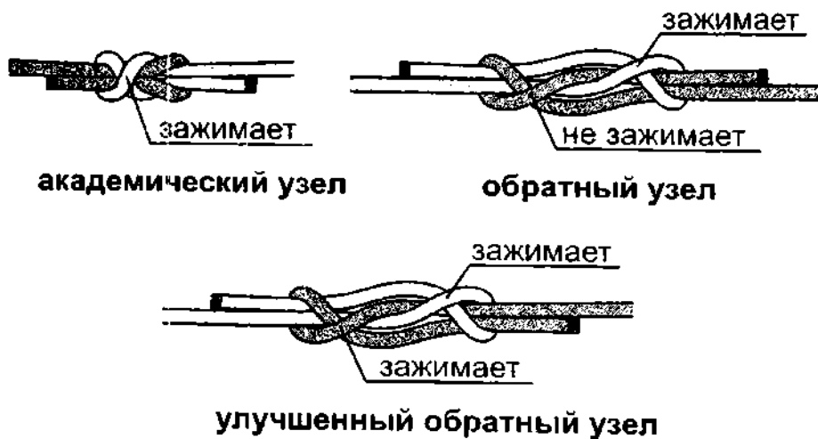
Рис. 820. Академический, обратный и улучшенный обратный узлы.
