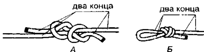
Рис. 20. Рыбацкий узел А и дубовая петля Б имеют изгибы не крутые, так как они огибают два конца верёвки. Поэтому эти узлы ослабляют верёвку не сколько изгибами, сколько своей тугостью.
