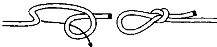
Рис. 363. 3-й способ вязки скользящего простого узла . Скользящий простой узел вяжется из калышки .
