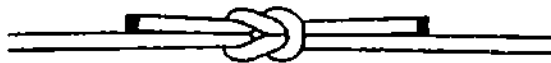
Рис. 798. Прямой узел . Коренные концы должны находиться на одной линии, а ходовые концы должны выходить из узла параллельно им.
