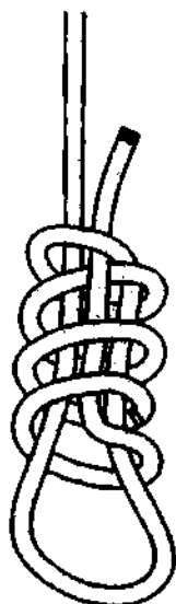
Рис. 372. Вариант вязки эшафотного узла.
