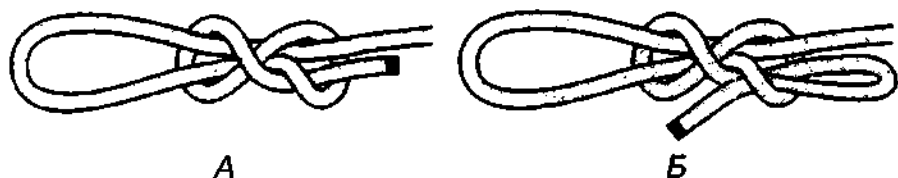
Рис. 379. А – силковый узел; Б – быстроразвязывающийся силковый узел.
