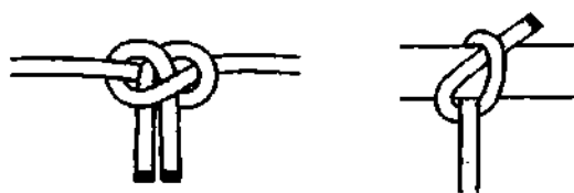
Рис. 9. На первый взгляд слабые и ненадёжные травяной и самозатягивающийся узлы при соблюдении условий безопасности являются очень крепкими и надёжными узлами.
