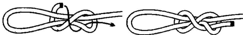
Рис. 380. 1-й способ вязки силкового узла . Силковый узел вяжется из девятки .
